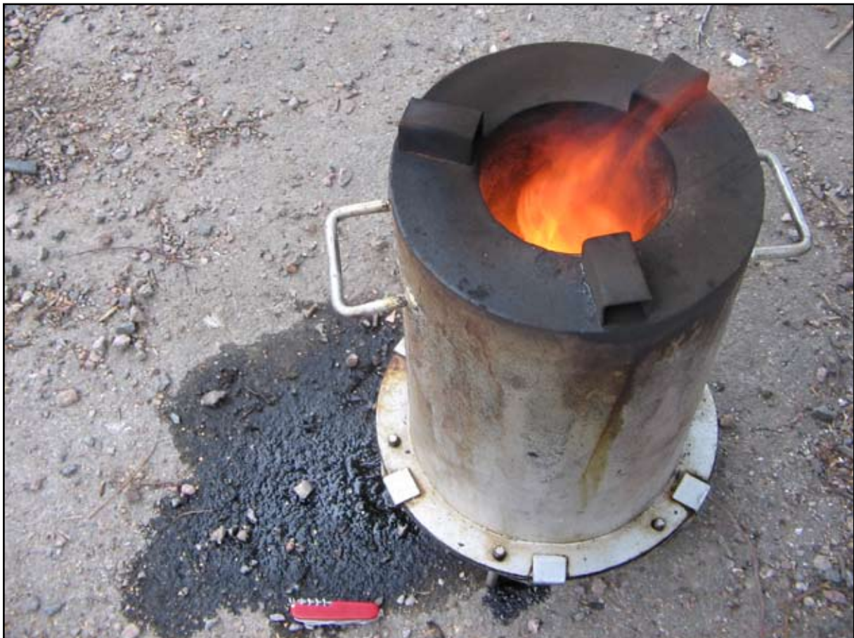
Kuva 5. Anilakeittimet pystyvät ruuanlaiton sivutuotteena hiiltämään palotilaa kiertävässä lieriössä hienojakoista biomassaa (esimerkiksi neulasia, lehtiä tai maissin tähkiä) korkealaatuiseksi puuhiileksi, jota voi käyttää peltojen ja puutarhojen maanparannusaineena tai josta voi tehdä poltettavia puuhiilipuristeita.
